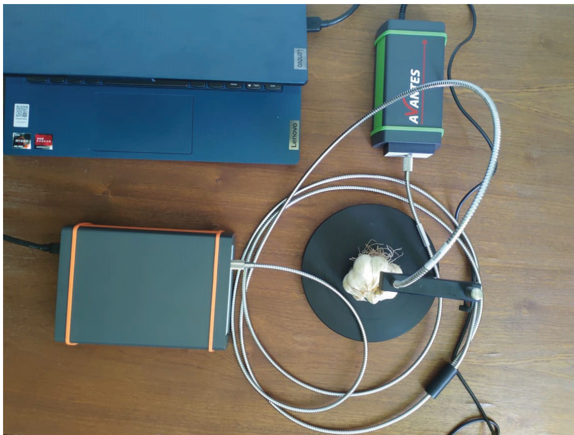
Фигура 1. Общ вид на експерименталната инсталация, приложена за флуоресцентна спектроскопия Figure 1. General view of the experimental installation used by fluorescence spectroscopy
