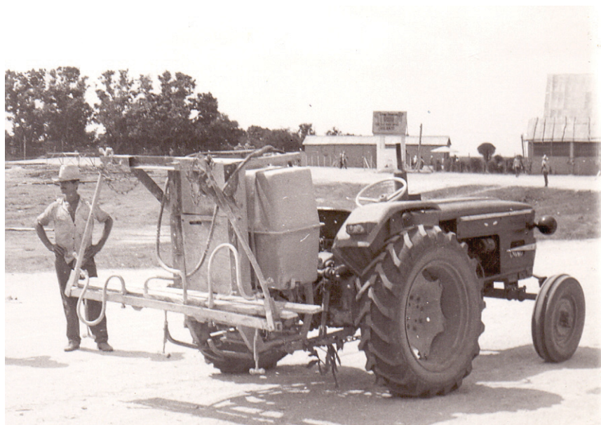
Фиг. 4. Пръскачка за пръскане на тютюн за пури на база на Перла 11
