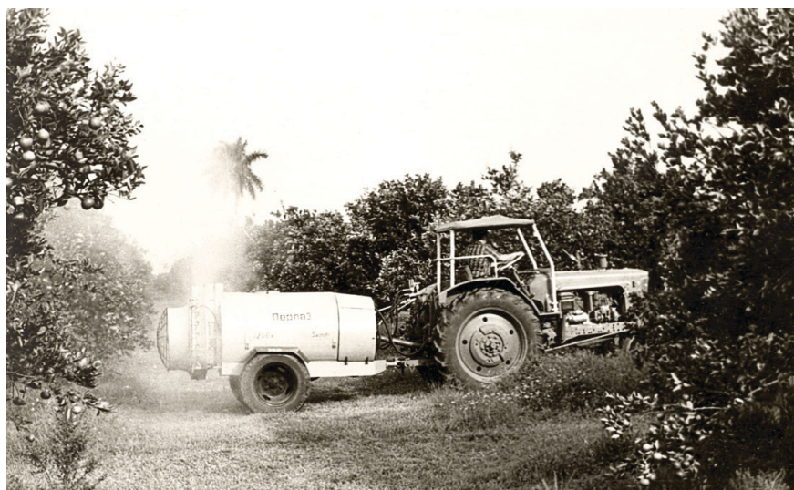
Фиг. 5. Вентилаторна пръскачка Перла-3
