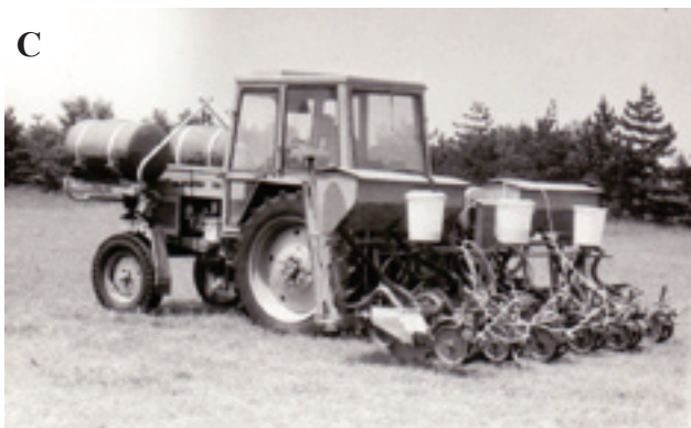
Фиг. 9. Универсална хербицидна уредба УХЛ-8М Fig. 9. Machines for treatment with herbicides УХЛ-8М
