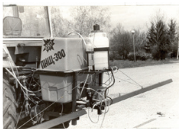
Фиг. 17. Пръскачка навесна ПНЩ-300 Еко Fig. 17. Tractor-mounted boom sprayer ПНЩ-300 Еко
