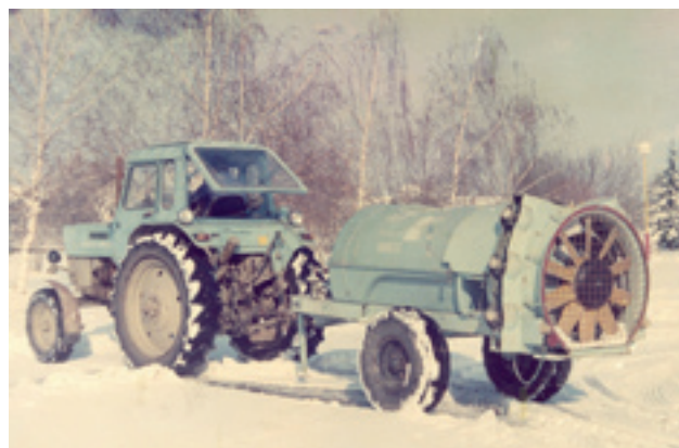
Фиг. 13. Пръскачка за ултрамалообемно и малкообемно пръскане ПЕРЛА-9УМП Fig. 13. Sprayer for ultra-small volume and small volume spraying ПЕРЛА-9УМП
