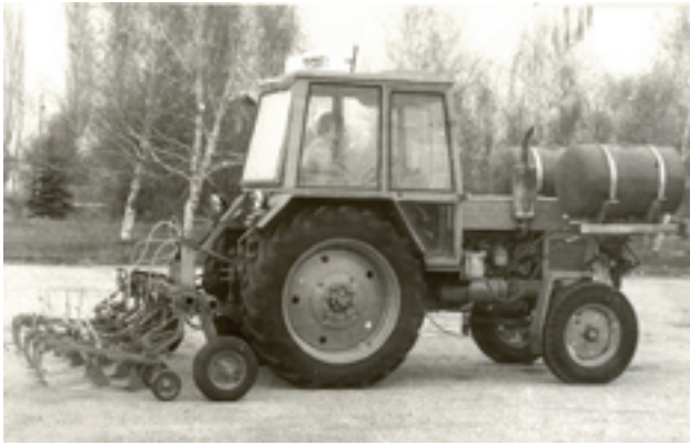
Фиг. 10. Универсална хербицидна уредба УХЛ-8М с автоматично водене на култиватора
