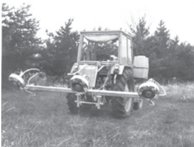
Фиг. 8. Пръскачка за зеленчуци и тютюн (1983) Fig. 8. Sprinkler for vegetables and tobacco (1983)
