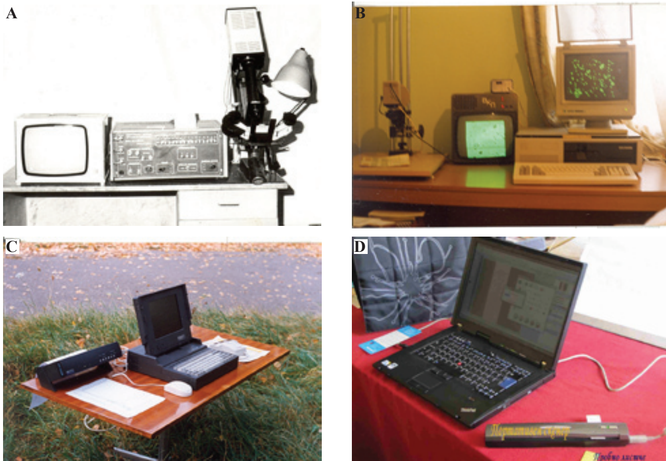
Фиг. 3. Системи за анализиране на капкови покрития: първо поколение 1979 (А), второ поколение 1987 (В), трето поколение 1993 (С), четвърто поколение 2010 (D)
