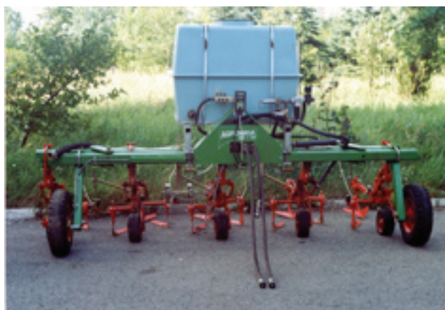
Фиг. 12. Уредба хербицидна лентова УХЛ-300 Fig. 12. System for treatment with herbicides УХЛ-300
