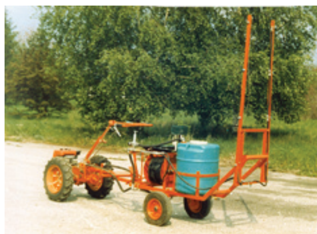
Фиг. 16. Универсална пръскачка за мотокултиватор ПУМК 0,1; Перла-160; Перла-200 Fig. 16. Universal sprayer for moto cultivator ПУМК 0,1; Перла-160; Перла-200
