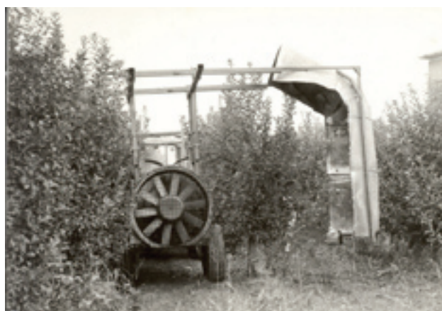
Фиг. 23. Пръскачка Перла-9 с екран за улавяне на работната течност непопаднала на растението
