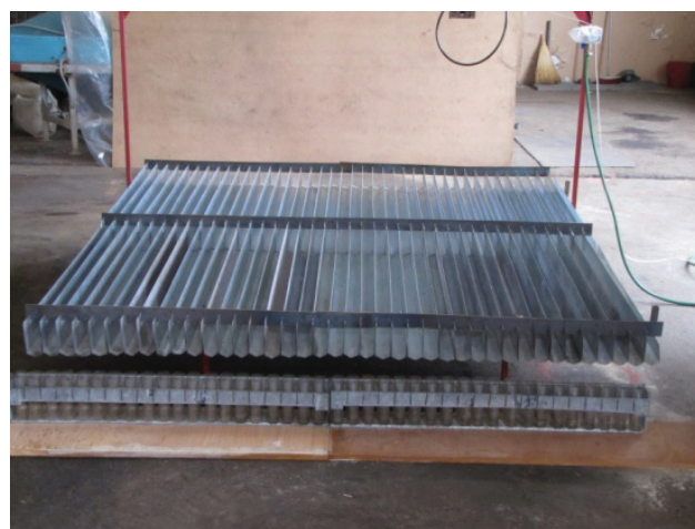
Фиг. 4. Общ вид на улейната събираща тава Fig. 4. Overview of the patternation system
