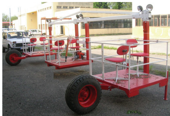
Фигура 1. Опитен образец на тримодулна работна машина за механизираниро прибирането на цвета от насаждения с маслодайна роза
