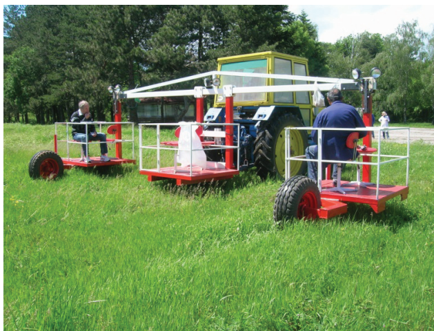
Фигура 3. Експериментална проверка на здравината на конструкцията на тримодулната машина за рози в състава на МТА
