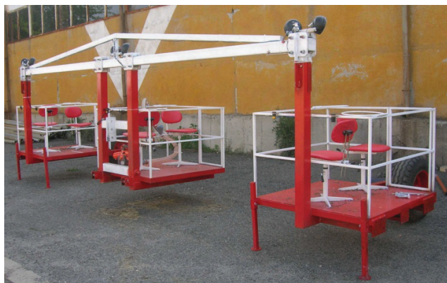
Фигура 1. Опитен образец на тримодулна работна машина за механизираниро прибирането на цвета от насаждения с маслодайна роза
