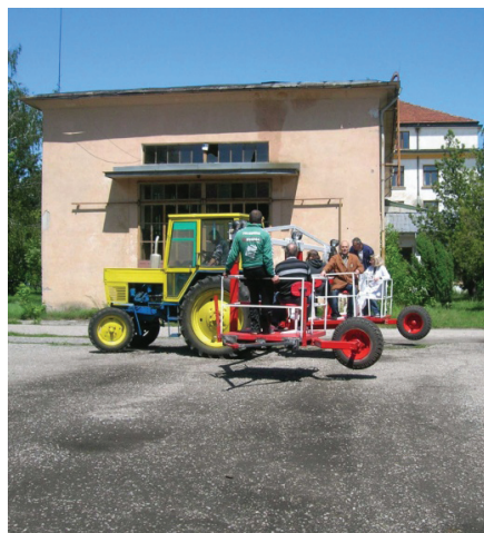
Фигура 3. Експериментална проверка на здравината на конструкцията на тримодулната машина за рози в състава на МТА
