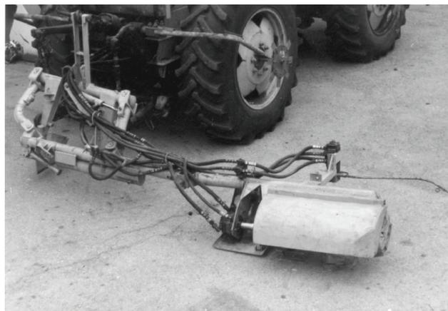
**Рис. 7.** Модернизированная фреза ФА-0,76
