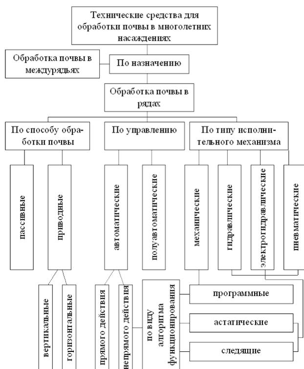
**Рис. 1.** Классификация устройств для обработки почвы в садах
