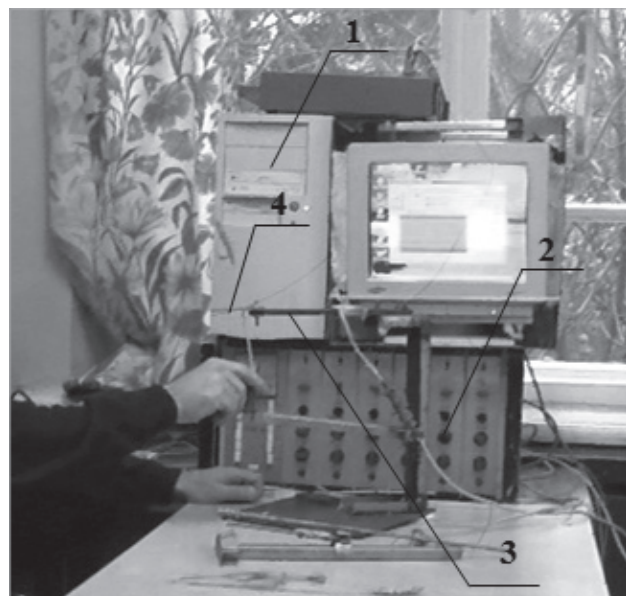
Рис. 3. Лабораторная установка для определения усилий, разрушающих колос, и продолжительности их действий 1- компьютер; 2 - усилитель сигнала TDA-6; 3 - тензобалка; 4 - пластина с канавкой (5 мм; 6 мм; 7 мм; 8 мм); 5 - наконечник; скоростная кинокамера (не показаны)
